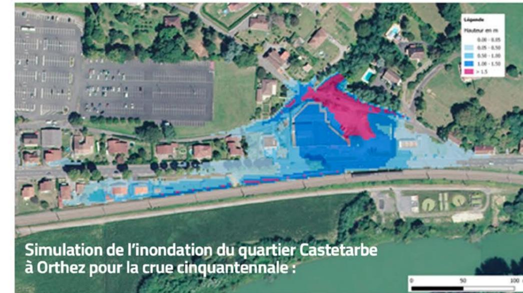
Simulation de l'inondation du quartier Castetarbe à Orthez pour la crue cinquantennale :
